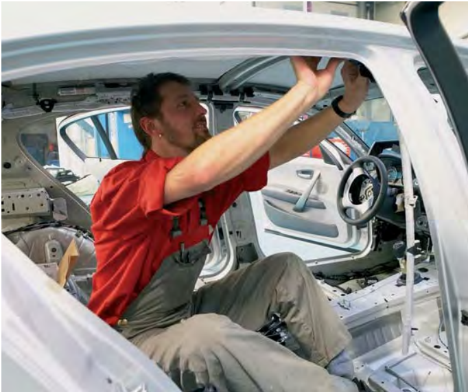
Voor de dit jaar beginnende 130i Cup gaat Carly Motors drie jaar lang de preparatie en begeleiding doen. Nu eerst 25 auto's klaar maken, en da's niet alleen maar technische microchirurgie: interieur strippen en een rolkooi inbouwen.
