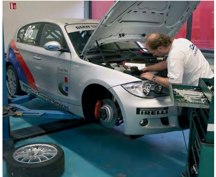
Omdat de BMW 130i Cup betaalbaar moet zijn worden de auto's minimaal gewijzigd en hun motoren verzegeld. Andere veerpoten en spoorverbreeders onder de racewielen komen er wel aan te pas.
